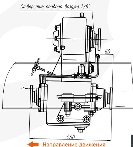
ВЫХОДНОЙ ФЛАНЕЦ КОМ КАМАЗ Ф120
