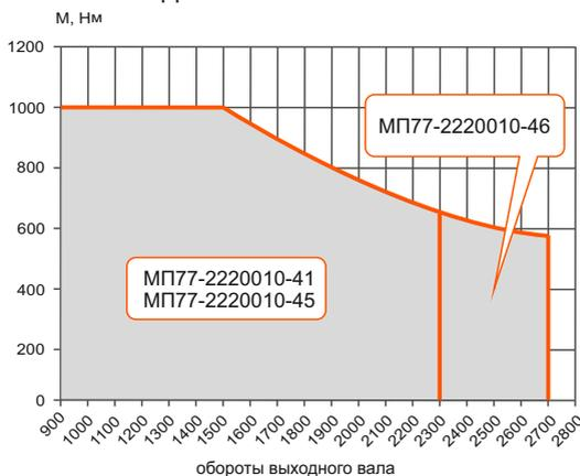
ПРИ ОТБОРЕ МОЩНОСТИ РЕКОМЕНДУЕТСЯ РЕЖИМ РАБОТЫ ДВИГАТЕЛЯ 1400...1700 ОБ/МИН
