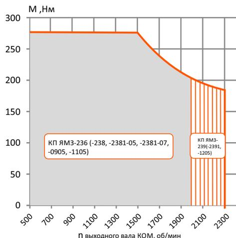
ПРИ ОТБОРЕ МОЩНОСТИ РЕКОМЕНДУЕТСЯ РЕЖИМ РАБОТЫ ДВИГАТЕЛЯ 1400...1700 ОБ/МИН
