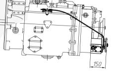
МП47-4209010-41 - ВЫХОД ДЛЯ УСТАНОВКИ ГИДРОНАСОСА ПО ISO 7653
