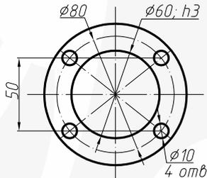
ВЫХОД ДЛЯ УСТАНОВКИ ГИДРОНАСОСА НШ32 (НШ50)
